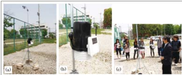
図4 熊本学園大学内に設置された気象観測装置（米国Davis社製 VantagePro2）
