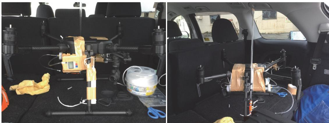
図7 2回目の阿蘇中岳第一火口上の火山ガス計測におけるドローンへの観測機器の取り付けの様子 (2018年8月1日および2日の観測での機器構成)
