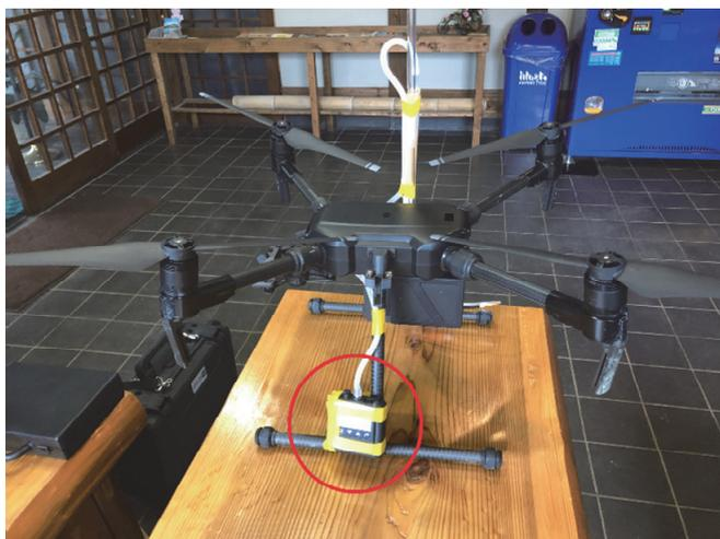
図8 気体採取用のポンプの取り付け位置（赤丸の中）
