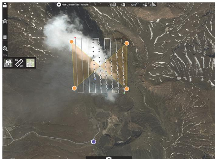
図 3 2016 年 2 月 18 日阿蘇中岳第一火口上空における DJI 社製「Phantom 3 Professional」の飛行経路
