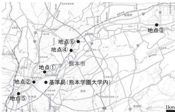
図11 ローカル・エリア RTK-GNSS 測量を行った地点と基準局設置場所（熊本学園大学）
