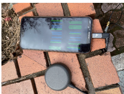
図10 Rtkgps+ とスマートフォンを利用したローカル・エリア RTK-GPS 測量
