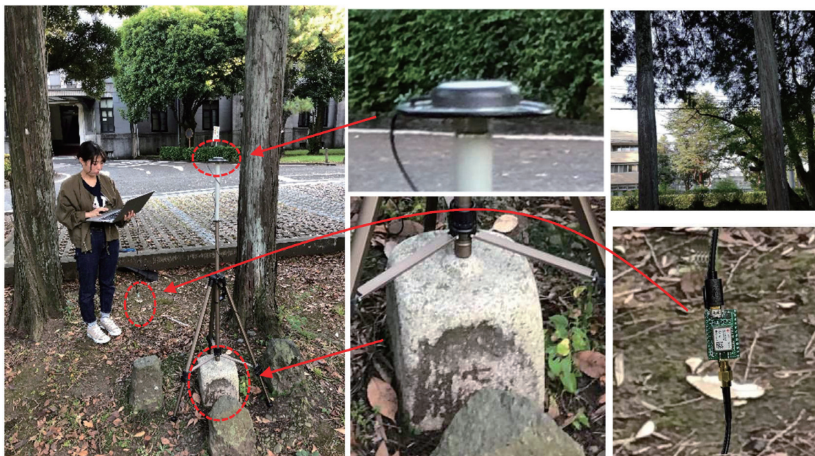
図 12 熊本大学内の一等水準点 (L010000001875) におけるローカル・エリア RTK-GNSS 測量の様子 (左) と上空の様子 (右上)、水準点の標石 (中央下)、アンテナ部分 (中央上)、受信機 NEO-M8P-0 (右下) の拡大写真
