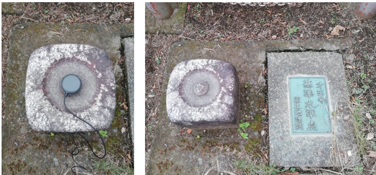
図 15 地点⑥の基準水準点の標石（右）と測量の様子（左） 周辺が構造物で囲まれているとマルチパスの影響が強くなり、上空が開けていないと使用できる衛星が少なくなるために三脚等によって高い場所にアンテナを設置する必要があるが、設置の際の誤差によって数値が悪くなる可能性がある。比較的開けていれば球分体の上に直接アンテナを乗せることによって、設置による誤差をなくすることができる。
