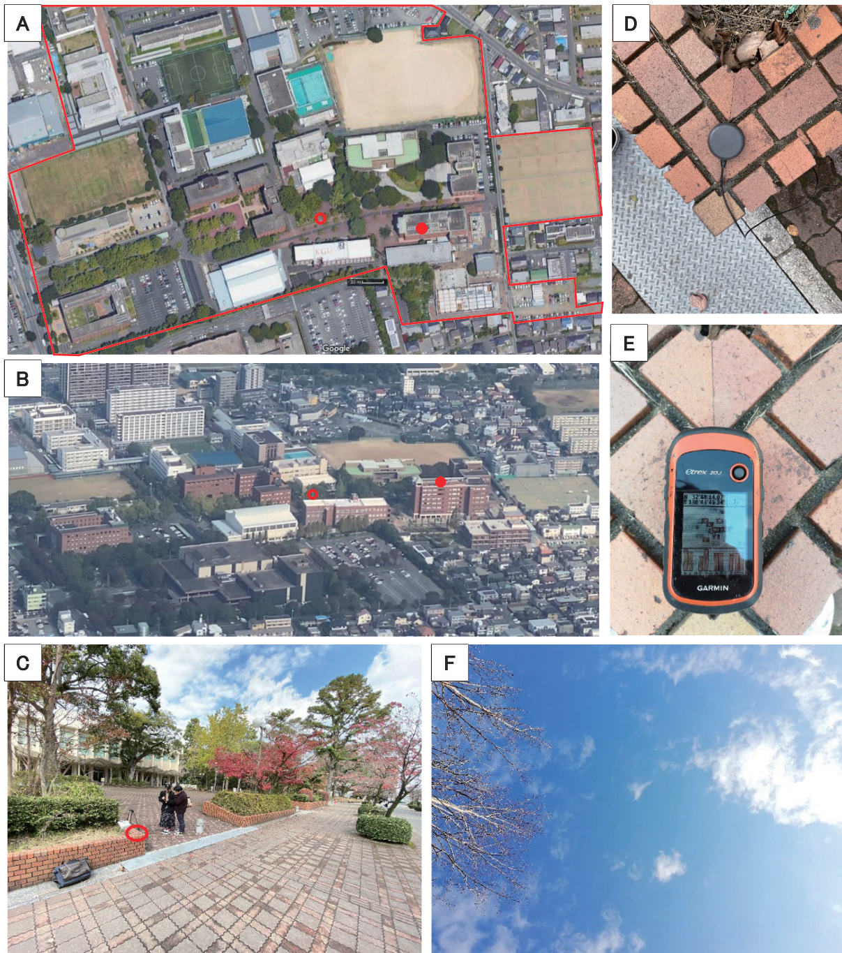
図3 熊本学園大学内におけるローカル・エリア RTK-GNSS 2 の連続測量
