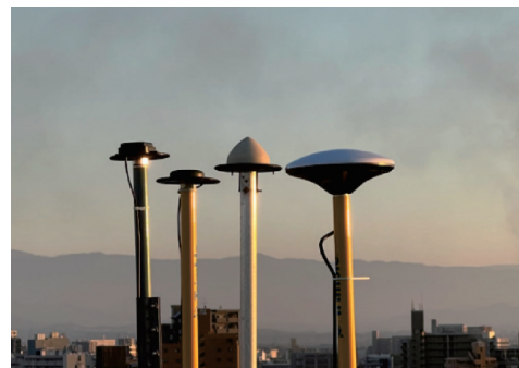
図2 屋上定点に設置した基準局および移動局
