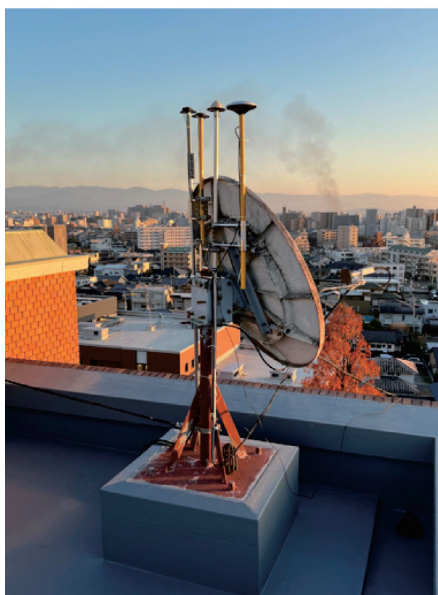
図2 屋上定点に設置した基準局および移動局
