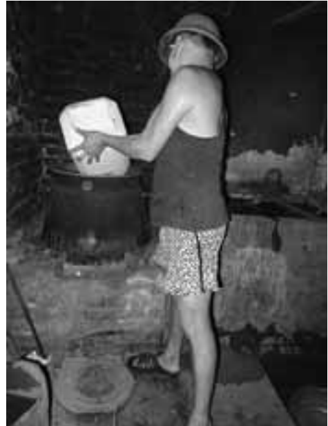
図2-11 蒸留釜に水を入れる様子
